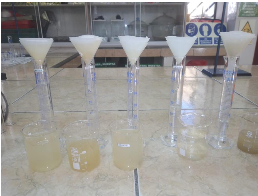
Fotografía 6. Filtración de muestras de aguas
