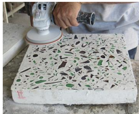
1f: Segundo pulido del terrazo con vidrio.
