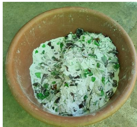
2b: Elaboración de mezcla de cemento, marmolina y vidrio.
