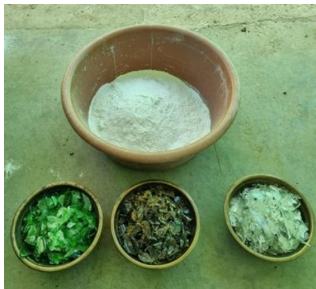
1a: Marmolina, cemento blanco y vidrio triturado.
