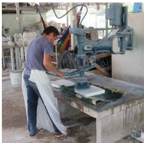
1c: Pulida inicial, en esta se elimina la capa superficial del cemento y las puntas al vidrio.
