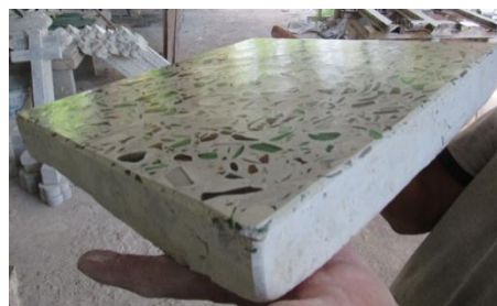
1h: Pieza de terrazo con vidrio terminada.
